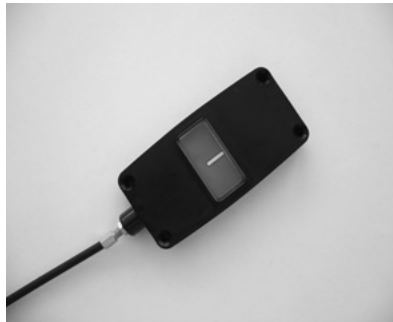
Figure 78 L'indicateur de position indique que les contacts principaux sont fermés
