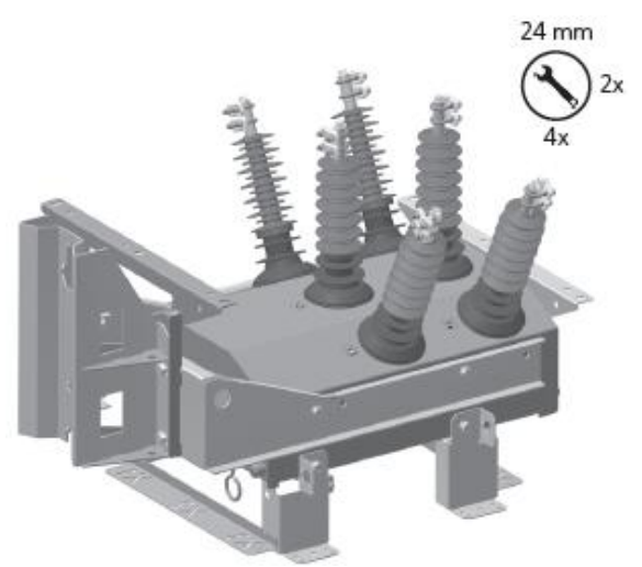
2. Ajustar el soporte de interfaz para poste utilizando los tornillos M16
