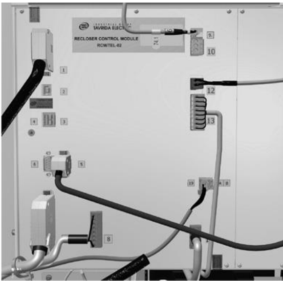
Figura 12 Conexiones del RCM con otros módulos del RC
